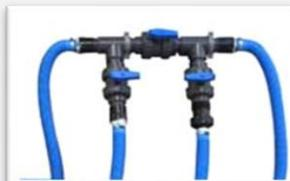
Le by-pass, composé de 3 vannes est placé après le filtre de piscine et avant les appareils de traitement automatique (régulateur automatique et électrolyseur de sel), il permet de régler le débit d'eau traversant la pompe à chaleur, mais également d'isoler la pompe pour l'entretien ou la maintenance.
